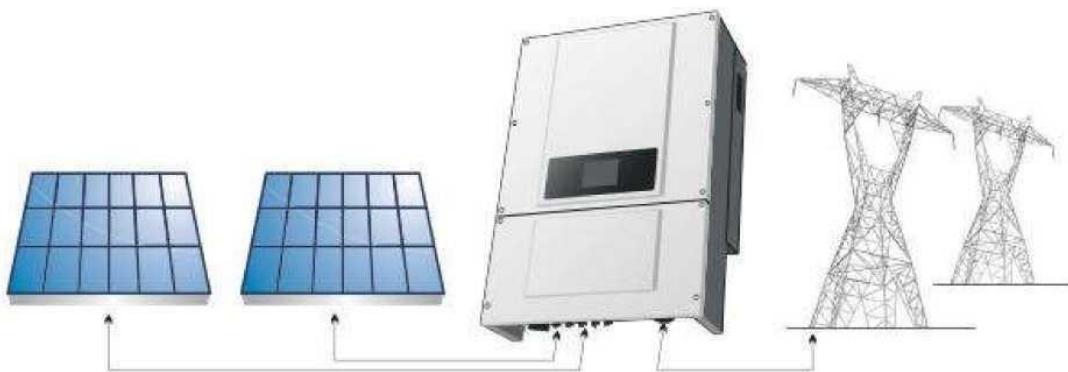
Рисунок 1 Сетевая солнечная электростанция
