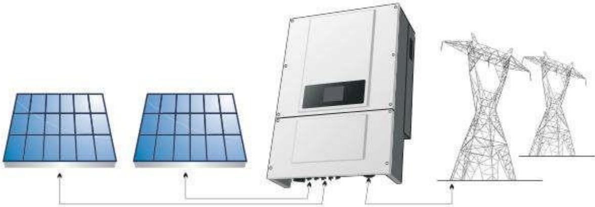
Рисунок 2-1 Фотоэлектрическая установка, связанная с электросетью
