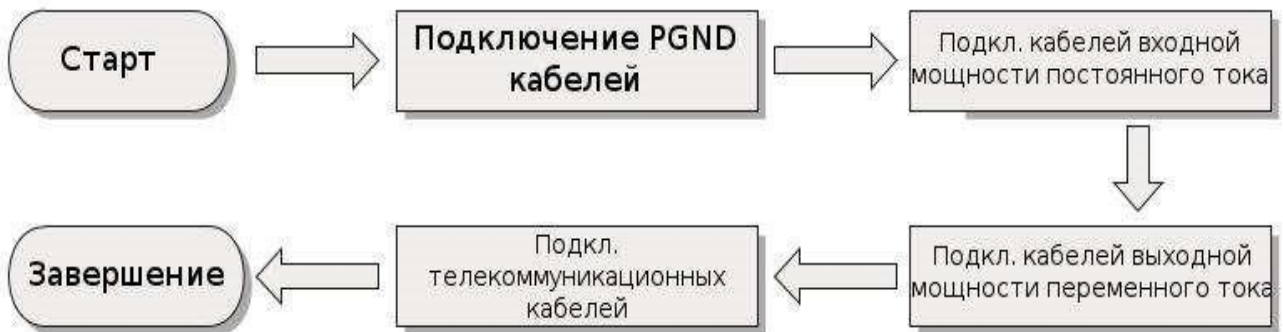
Рисунок 4-1 Блок-схема для подключения проводов к инвертору
